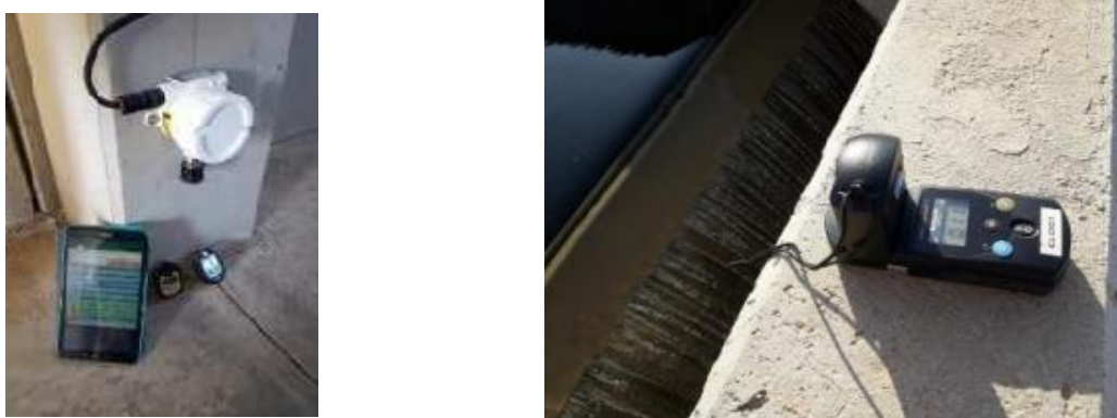
Treballs de control: Verificació de sensors de \text{SH}_2 – mesurament de clor lliure "in situ"
