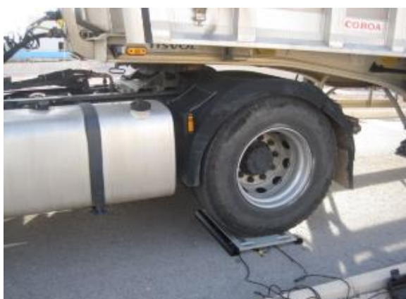
Treballs de control: treballs de verificació "in situ" de bàscules de pesatge i cabalímetres
