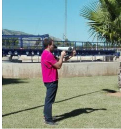
Trabajos de control de olores: instalación de medidores pasivos para la detección de olores - medición de gases "in situ" en ambiente
