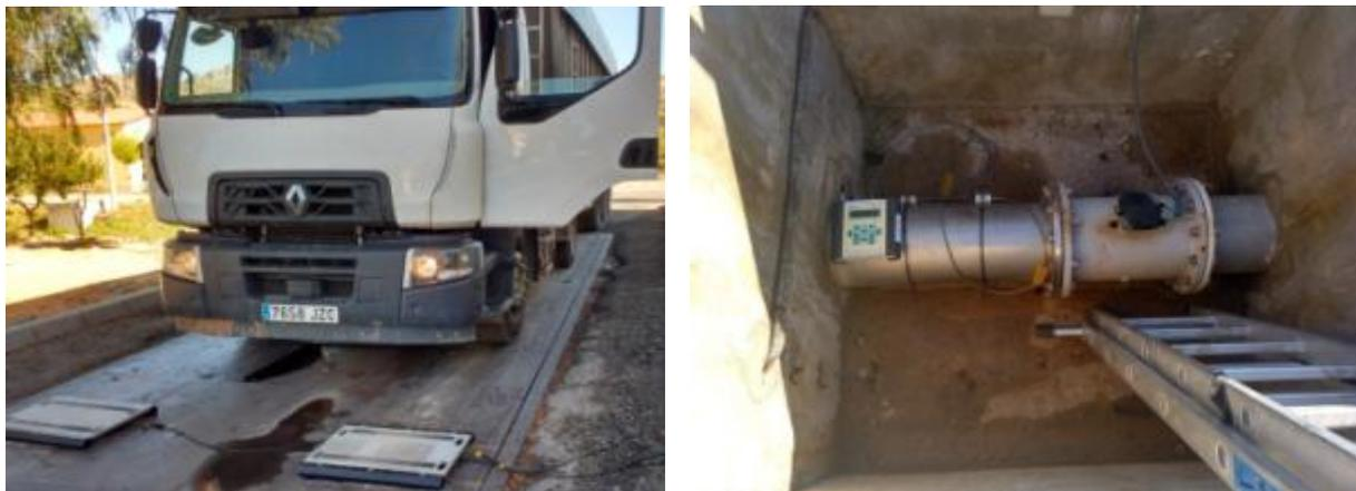
Trabajos de control: trabajos de verificación "in situ" de básculas de pesaje y caudalímetros
