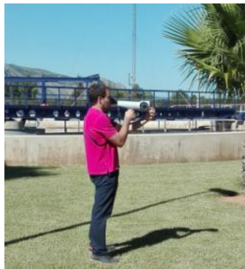
Treballs de control d'olors: instal·lació de mesuradors passius per a la detecció d'olors - mesurament de gasos in situ en ambient
