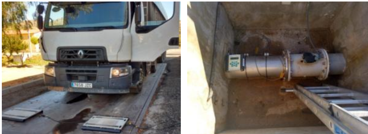
Treballs de control: treballs de verificació in situ de bàscules de pesatge i cabalímetres
