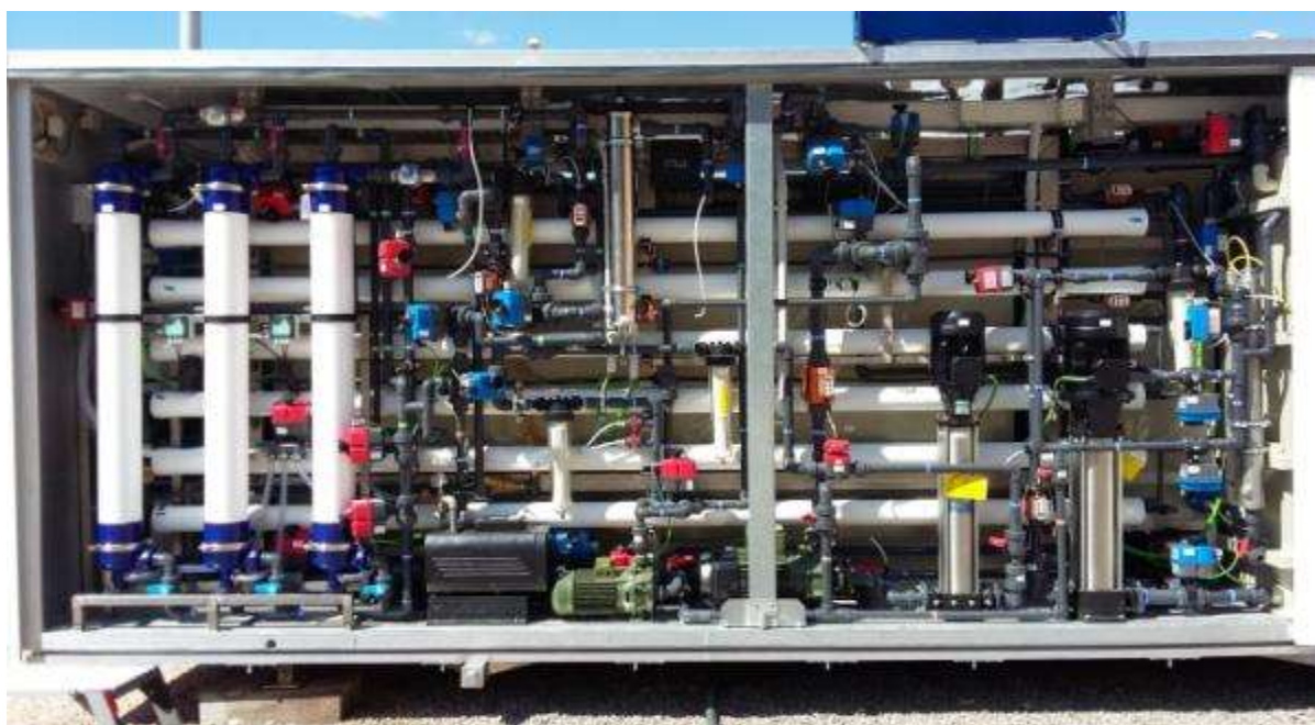
Planta pilot d'eliminació de contaminants emergents
