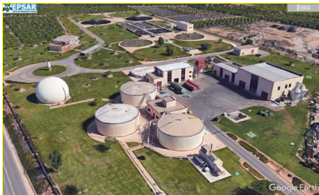
Instal·lació de digestió de llots de depuradora i subproductes industrials en l'EDAR d'Alzira-Carcaixent
