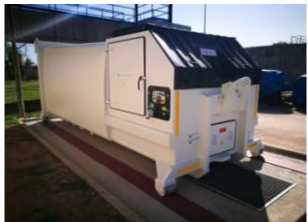
EDAR Sagunt. Instal·lació de compactador de residus
