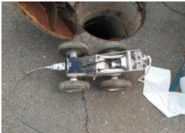
Robot para la inspección de colectores
