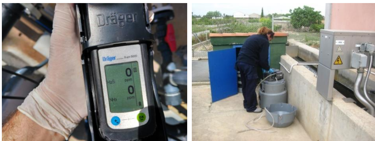
Trabajos de control: medición de gases en atmósfera – toma de muestras automática
