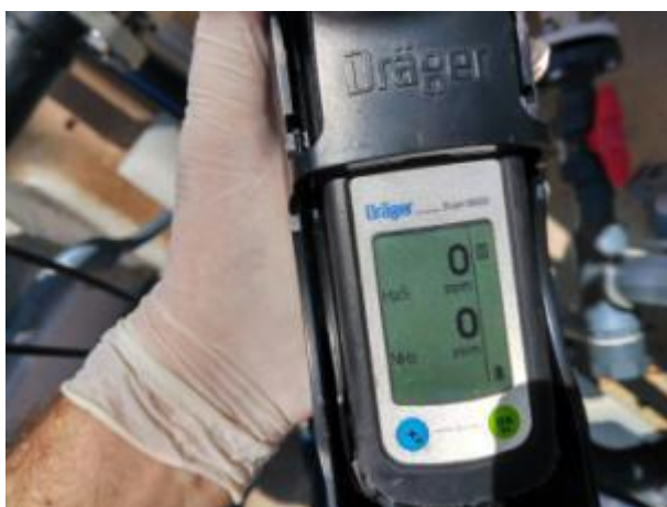
Treballs de control: mesurament de gasos en atmosfera – pren de mostres automàtica
