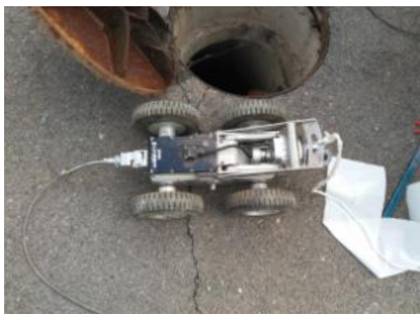
Robot per a la inspecció de col·lectors
