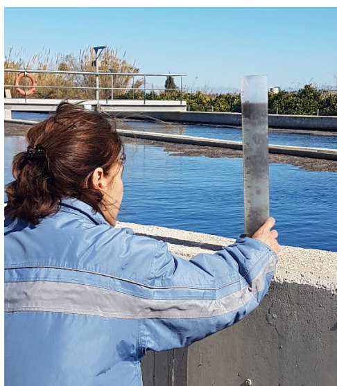
Comprobación sedimentabilidad del fango del reactor biológico
