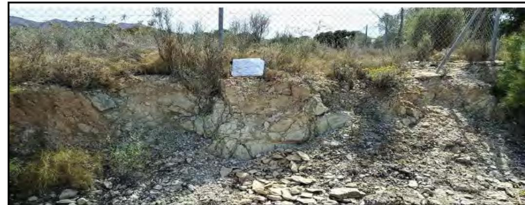
Detalle de la caliza estratificada, donde el macizo rocoso está finamente estratificado, fracturado y descompuesto (meteorizado) con lo cual es excavable sin la necesidad de martillo neumático.
