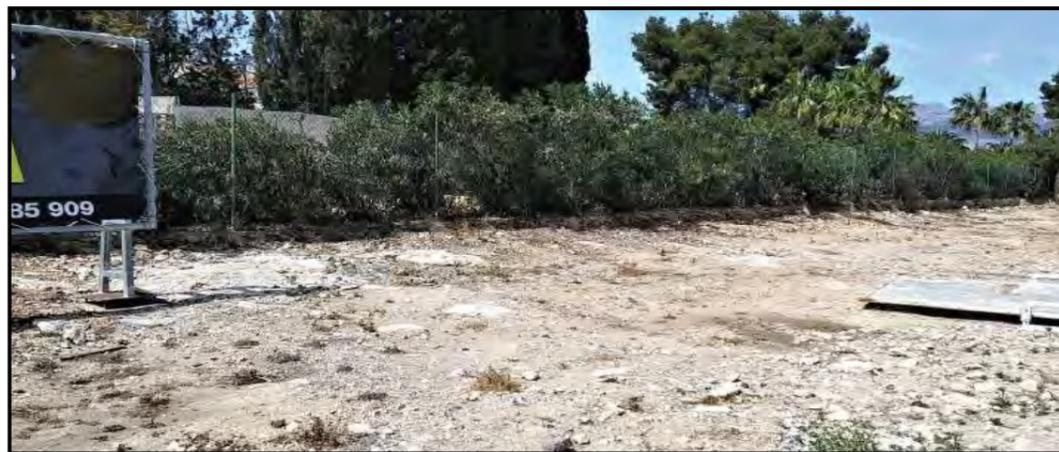
Se observa una costra calcárea rocosa que "tapiza" la superficie del terreno y que precisaría de martillo neumático para su excavación. Colector Cautivador Este.
