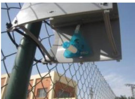
Trabajos de control de olores: instalación de medidores pasivos para la detección - medición de gases "in situ" en ambiente
