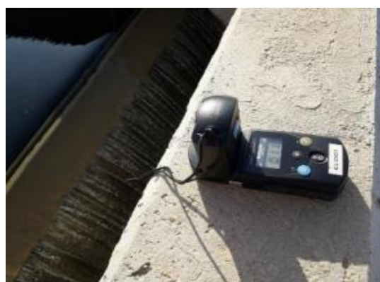
Trabajos de control: Verificación de sensores de SH 2 – medición de cloro libre "in situ"
